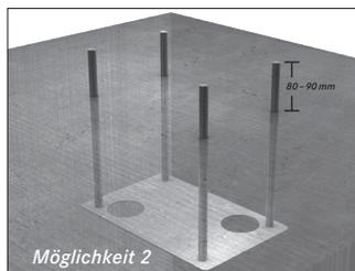
Ankerplatte wird im Vorwege ins Fundament eingelassen. Die Stifte müssen 80 - 90 mm aus dem Boden schauen.
