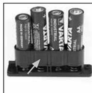
Вставьте крышку и батарейки в электронное устройство и прикрутите ее.
